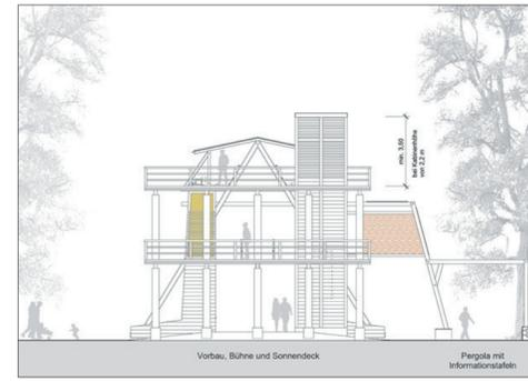
Die Ostansicht zeigt, wie der Vorbau mit dem Aufzug am Eingang zum neuen Gradierwerk angebaut wird.
